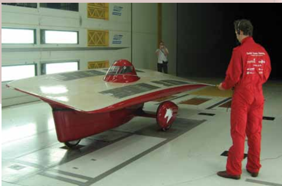
In de windtunnel van DNW voerde Solar Team Twente een fullscale test uit.
